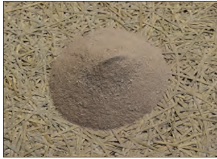
Nach der thermischen Verwertung der Holzwolledeckenplatten bleibt das Bindemittel auf Magnesit-Basis übrig und wird in die Produktion zurückgeführt. © Foto Glanznig
